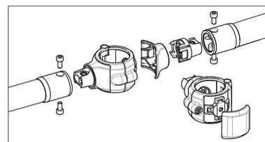
3本以上の連結設置を行う場合、接続ブラケットをご利用いただくか、お手持ちのブラケット組み替えにより、木手すりを連続し設置してください。
