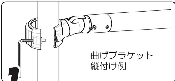
**1** 伸縮手すりの太い方のパイプ側をベスポジ本体に固定します。
