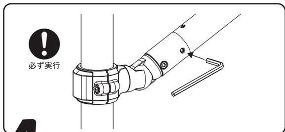
**4** 最後に手すりの伸縮を固定させるため右回りにレンチで「カチッ」と音がするまで、締めてください。
