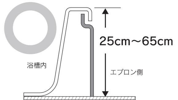
浴槽縁に対しての対応はプレートの動く $\pm 10^\circ$  以内で設置してください
