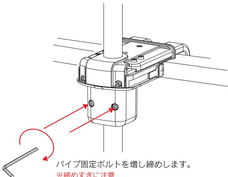
パイプ固定ボルトを増し締めします。
