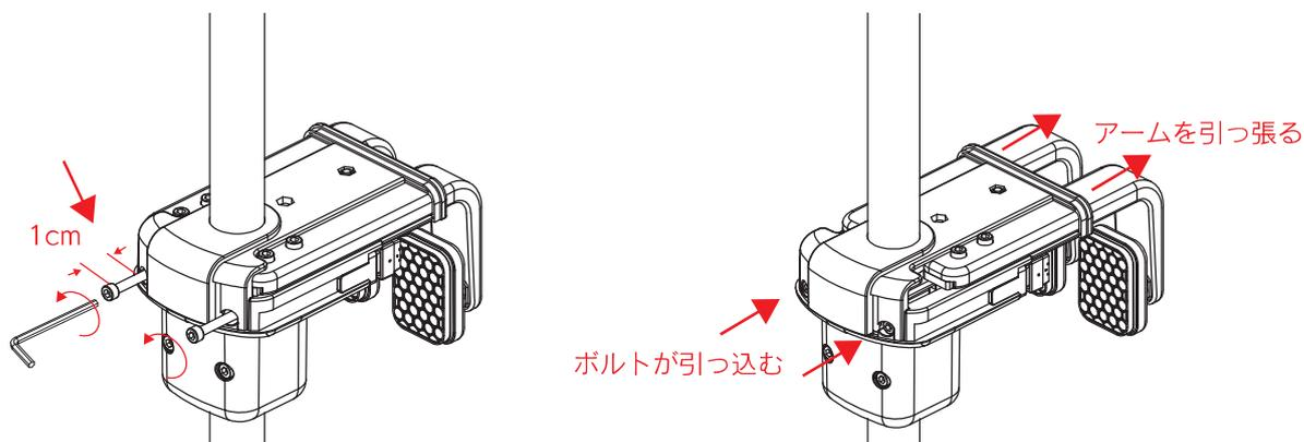
アーム締め付け整ボルトを反時計回りに回して
