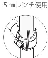
○天井ベースが外れにくい場合は、ロックを解除し持ち上げ、徐々に力を加えたり緩めたりし、天井表面を傷めないように注意して取外してください。急激な力をかけると天井表面を傷めます。
