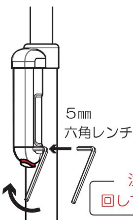
5mmレンチをカバーの穴に差し込み回します。
