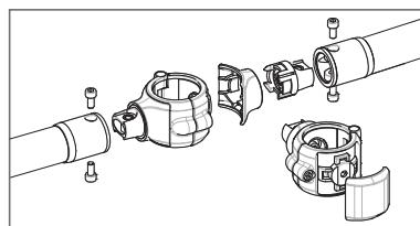
3本以上の連結設置を行う場合、接続ブラケットをご利用いただきか、お手持ちのブラケット組み替えにより、横手すりを連結し設置してください。
