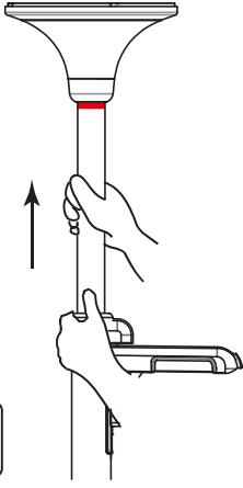
ロックレバーを直角に開き、上部パイプを少し伸ばし、ロックレバーを閉じます。
