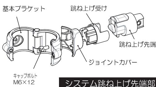
跳ね上げ先端部、跳ね上げ回転部の方向を合わせ手すりに差しこみ
